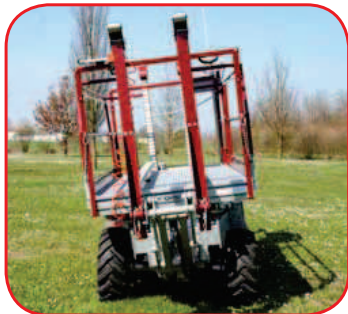
LIVELLAMENTO TRASVERSALE MOD. 135x2500 - 135x3000 - 185x3000 TRANSVERSAL LEVELING (MOD. 135X2500 - 135X2000 - 185X3000) QUER-HANGAUSGLEICH (MOD. 135X2500 - 135X2000 - 185X3000) NIVELLEMENT TRANSVERSAL (MOD. 135X2500 - 135X2000 - 185X3000) NIVELAMIENTO TRASVERSAL (MOD. 135X2500 - 135X2000 - 185X3000)
