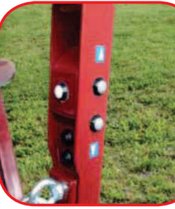
COMANDO ELEVATORE E START E STOP DALLA PIATTAFORMA START & STOP CONTROL FROM PLATFORM HEBER KONTROLLER UND START & STOP DER HEBEBÖHNE COMMANDE ELEVATEUR ET START & STOP DE LA PLATEFORME MANDO START & STOP DE LA PLATAFORMA
