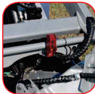
COMANDO ELEVATORE DA TERRA ELEVATOR CONTROL FROM GROUND (BACK) SAULENHEBER KONTROLLE VOM BODEN (RÜCKSETZIG) COMMANDE ELEVATEUR DU SOL (ARRIERE) COMANDO ELEVADOR DEL SUELO (POSTERIOR)
