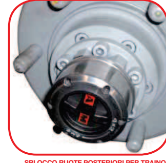
SBLOCCO RUOTE POSTERIORI PER TRAINO RELEASE OF BACK WHEELS FOR TOWING ENTKOPPELUNG DER HINTERRAEDER FÜR ZIEHEN DEVERROUILLAGE DES ROUES ARRIERES POUR REMORQUAGE DESBLOQUEO RUEDAS TRASERAS PARA REMOLQUE
