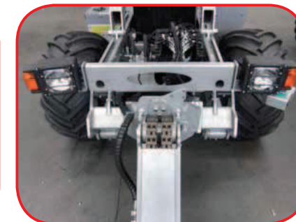
FANALERIA ANTERIORE REAR LIGHTS WITH PLATE SUPPORT RÜCKLICHTER MIT SCHILDHALTER FEUX POSTÉRIEURS AVEC PORTE PLAQUE LUZES POSTERIORES CON CHAPA
