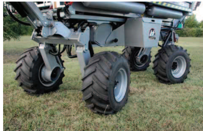
RUOTE INDIPENDENTI AUTOLIVELLANTI SELFLEVELLING INDEPENDENT WHEELS UNABHÄNGIGE SELBSTREGULIERENDE RÄDER ROUES INDÉPENDANTES AUTO-NIVELANTES RUEDAS INDEPENDIENTES AUTONIVELANTES
