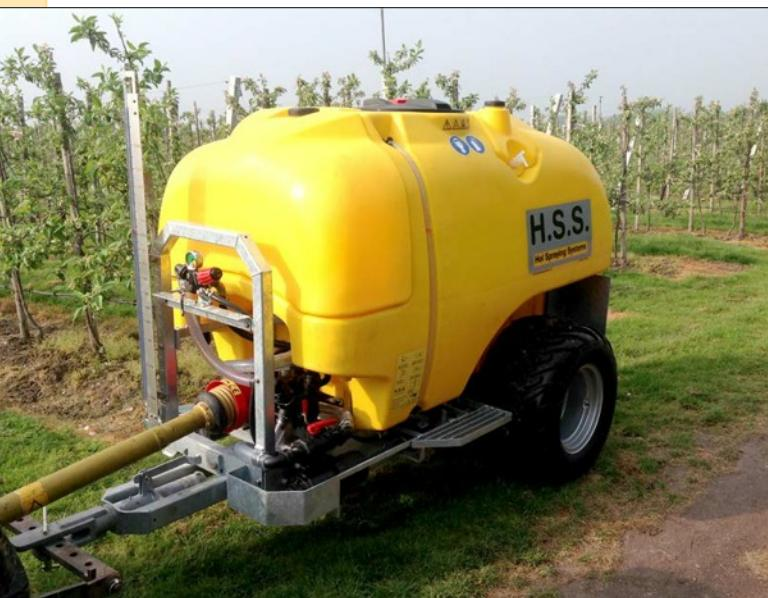
De HSS onkruidspuit is voorzien van een groot aanzuigfilter (capaciteit 220 liter per minuut). Handbediende kranen en drukregelaar. De manometer en niveau-aanduiding zijn vanaf de bestuurdersstoel duidelijk zichtbaar.
